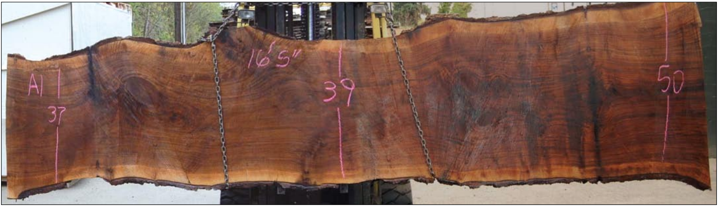
Abb. 2: Bohlen der Oregon-Walnuss werden zu enormen Preisen im Internet gehandelt; alle aufgetragenen Maße in Zoll (Inch; = 2,54 cm); Beschreibung: Stripe, curl, 4 knots, Stärke 7,6 cm, Länge 5 m, Breite 94, 99 127 cm; Preis 4 480 $ US (ca. 2 825 €)
