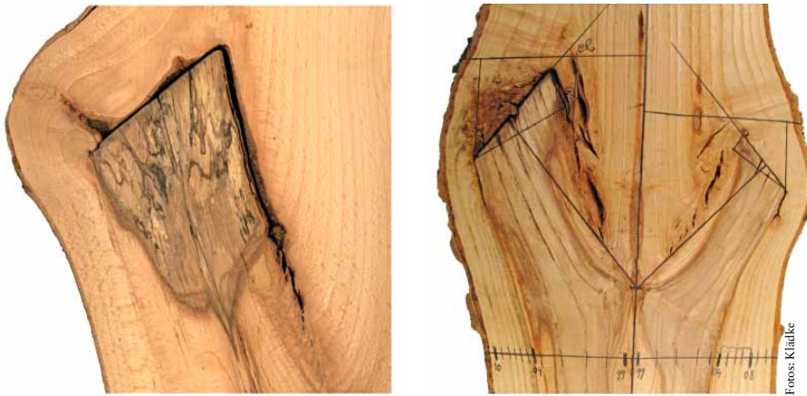
Abb. 2: Links im Astholz eingeschlossene Weißfäule nach Grünastung (Buche, Astdurchmesser 60 mm), rechts Stammverfärbung an einer Esche nach Grünastung mit eingezeichneten Messlinien (Astdurchmesser 47 u. 30 mm). Bei der oberhalb der Schnittfläche des linken Astes erkennbaren porösen Struktur handelt es sich um Korkgewebe, das vom Baum vermutlich zum schnelleren Wundverschluss gebildet wird [14].
